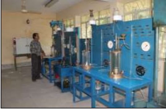
Triaxial Shear Test Apparatus: মাটির নমুনার Shearing strength বের করার জন্য ব্যবহৃত হয়।
