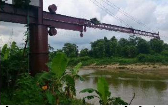
চিত্রঃ HKH-HYCOS প্রকল্পের আওতায় স্থাপিত সিলেটের Zakiganj Station এর RLS Hanging arrangement
