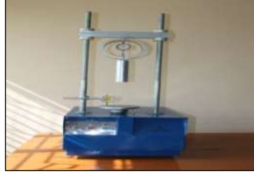
CBR Test Apparatus: মাটির নমুনার bearing capacity বের করার জন্য ব্যবহৃত হয়।
